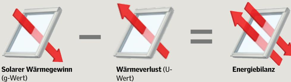
Die Wahl der optimalen Verglasung hängt auch von der Einbausituation im Gebäude ab. Bei Neubauten empfiehlt sich eine Dreifachverglasung. Bei Renovationen oder Austausch muss situationsbedingt entschieden werden, welche Verglasung am meisten Sinn macht. Dies ergibt sich aus den Anschlüssen sowie der Dämmung des gesamten Daches.
